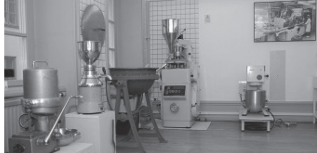
Fr. vä.: Press för extraktionsrester, emulsionsmaskin, mantlat värmebad för bl.a. salvor, rundlöpare samt blandare.
