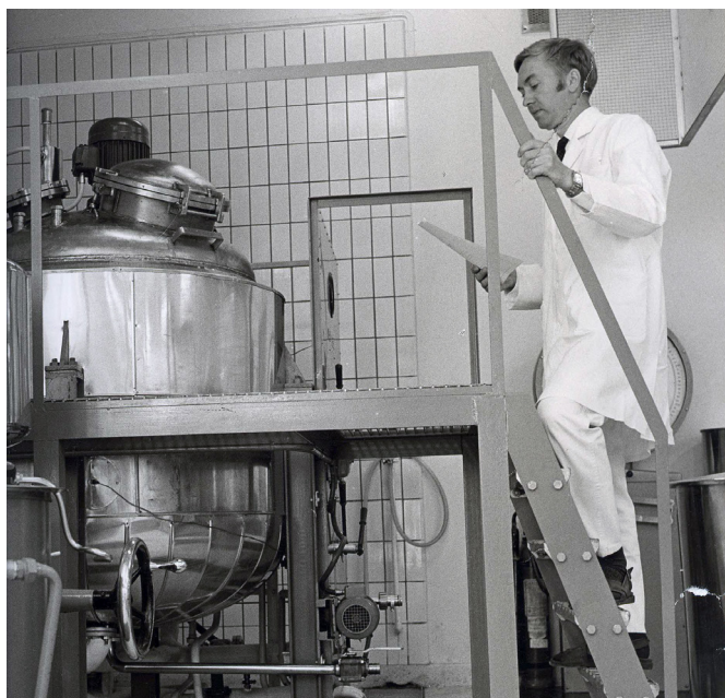
Kurt B inspekterar 1000 L kokare konstruerad tillsammans med Sten Olsson Ingenjörfirma.
